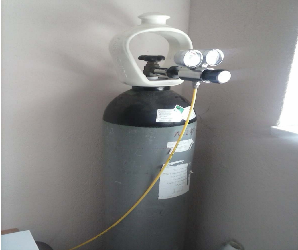
Εικόνα 6: Φιάλη αερίου με συμπιεσμένο άζωτο σε αέρια μορφή.
