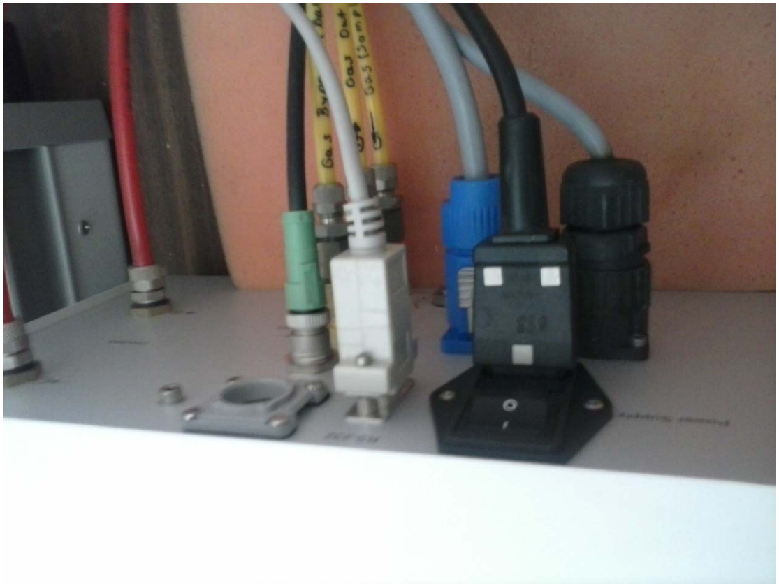
Εικόνα 5: Πίσω μέρος με τα σημεία που συνδέεται ο φούρνος με τις περιφερειακές συσκευές του.
